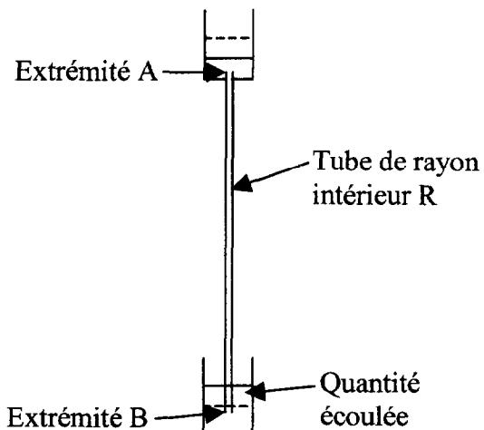
2. En écoulement laminaire, d'après la loi de Poiseuille, la perte d'énergie par frottement visqueux pour 1 kg de fluide, dans le tube de longueur L, est donnée par :
